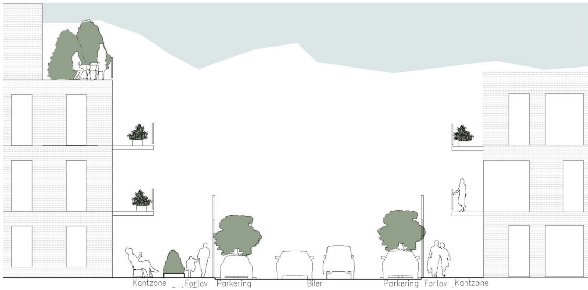
Principsnit i vestligste del af Arresøvej, på lokalplankort 2 benævnt vej B – C og C – D, hvor cykelstien er flyttet ud af vejprofilet
