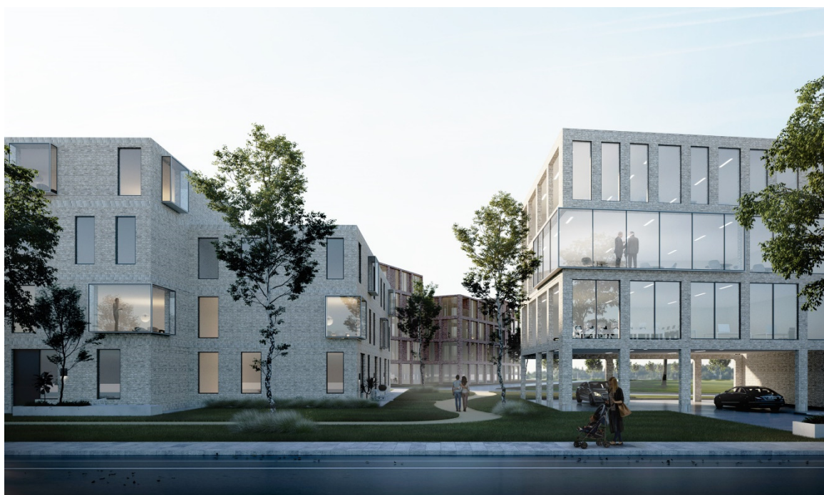
To eksempler på hvordan gårdbebyggelse ved Grenåvej kan fremstå, med arkitektonisk indpassede vindues- og karnapløsninger der hindrer støj fra vejen i at brede sig ind i boligerne.
