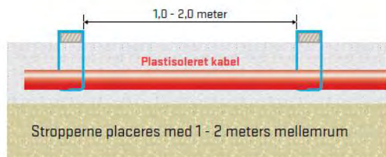
Figur 2 Eks. på ophæng af plastisolerede kabel i udgravning. Som udgangspunkt er plastisolerede kabel rød, men tidligere årgange kan have en anden farve.
